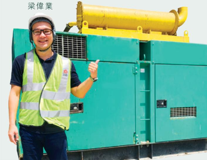
有鑑於柴油發電機排出的廢氣是建築工地空氣污染的主要來源之一，故此協興研發並安裝了一部名為「文氏旋風分離器」的創新設備。分離器借助發電機廢氣產生的動能把水份霧化，用以黏附廢氣中的污染物，再通過工地的污水處理設施加以處理，然後排放到工地外的都市排水系統。經處理的污水符合非常嚴格的水質標準。
